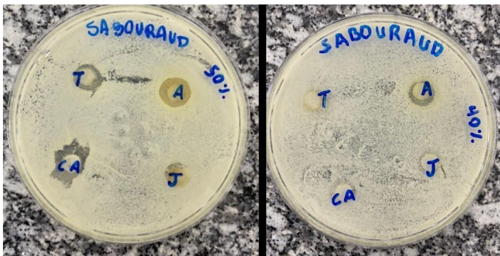
Figura 5 – Teste de inibição de crescimento com Candida albicans utilizando extratos de 50% e 40% (placas da esquerda e direita, respectivamente) das própolis das abelhas Tubuna (T), Apis mellifera (A), Canudo (CA) e Jataí (J). Fonte: os autores.
